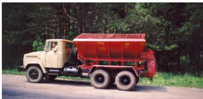
Рис. 1. Автомобиль КрАЗ-255Б1, оборудованный машиной для внесения минеральных удобрений и химических мелиорантов МРД-9А
